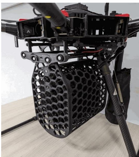
Рис. 2. Устройство для дозирования и внесения энтомофагов навешенное на БПЛА.
